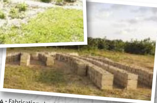
4 - Fabrication des briques de maçonnerie.
